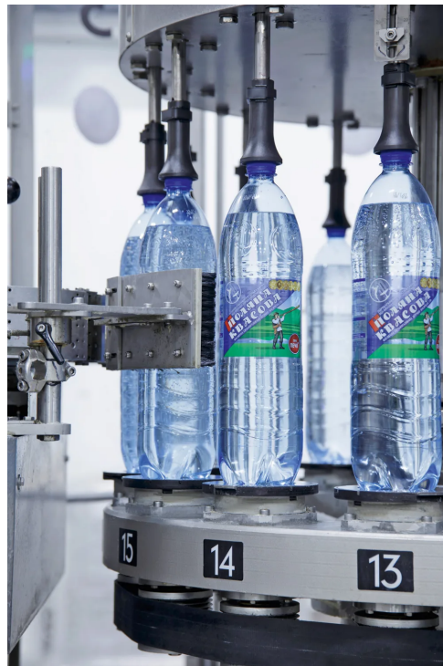
↑ En la etiquetadora Rollfed Innoket Neo, las botellas reciben etiquetas transparentes con No-Label-Look.
