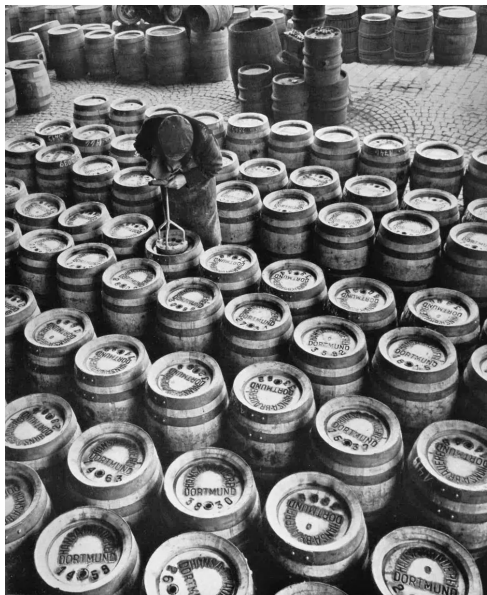
↑ In der Hansa-Brauerei werden neue Holzfässer mit Hilfe eines Brandeisens in Handarbeit mit dem sogenannten Firmenbrand versehen.
